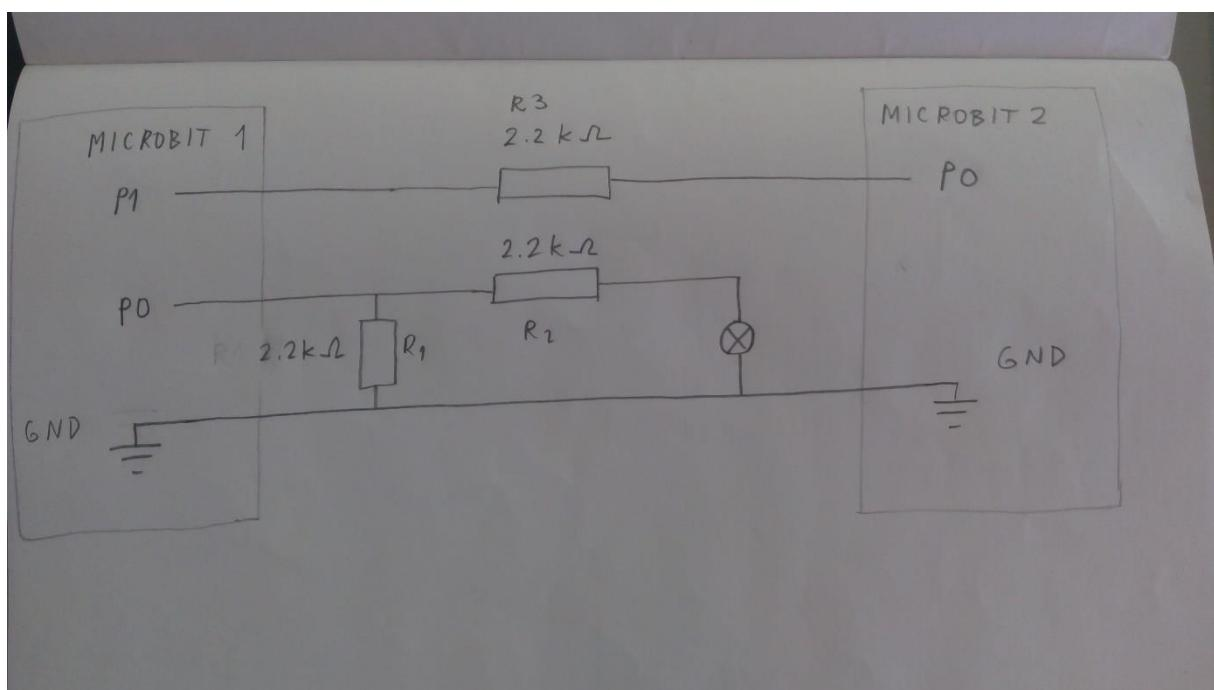
Prvi Microbit očitava analognu vrijednost te ovisno o njenoj veličini prikazuje željenu sliku, a digitalnu vrijednost spremi na izlaz koji je spojen sa drugim Microbitom.
